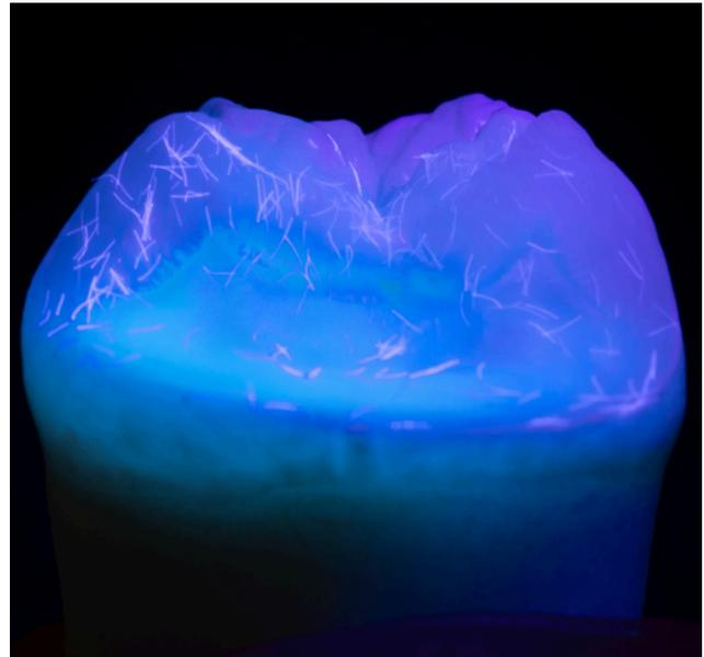
Abb. 2 Nahaufnahme unter Schwarzlicht von abgelösten Faserflocken bei Verwendung eines konventionell beflockten Dentalapplikators.
